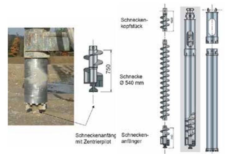
Grundsätzliche Konstruktionsmerkmale für das Bohrwerkzeug beim Doppelkopfbohren
