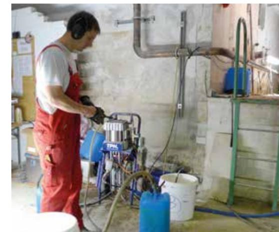
Bild 9: Pneumatisch betriebene Kolbenpumpe (Quelle: TPH.)
